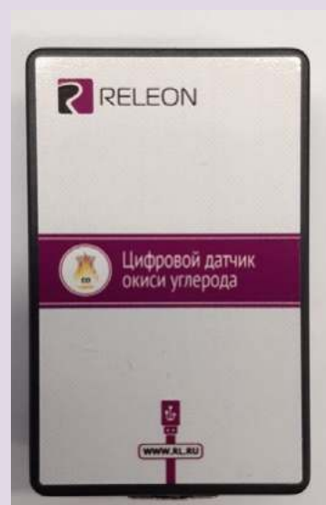
Рис. 11. Датчики кислорода (слева) и угарного газа (справа)
