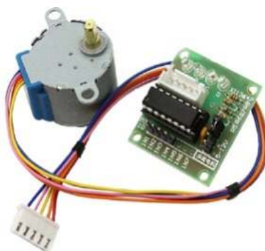
Рис. 20. Шаговый двигатель 28BYJ-48
