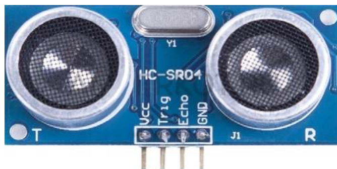
Рис. 16. Ультразвуковой датчик (дальномер)
