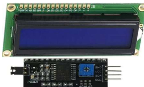
Рис. 17. Дисплей (жидкокристаллический индикатор — ЖКИ 16×2)
